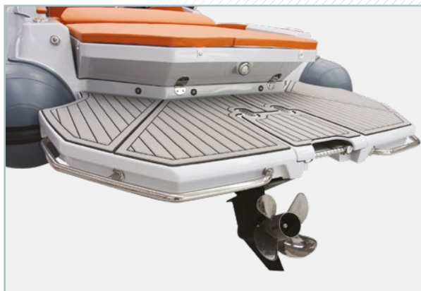
Plage de bain arrière et plan d'étagé revêtu en mousse Reflex
