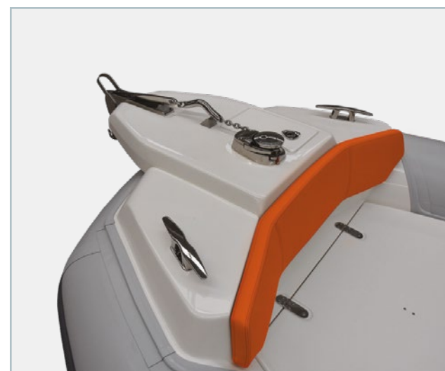
Option delphinière en fibre avec guindeau, corde/chaîne et ancre inox
