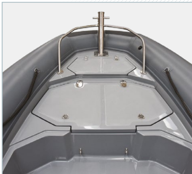
A la proue, un gros bollard en acier inoxydable renforcé par un balcon
