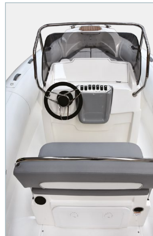
Console équipée de main-courante en acier inox, volant, système de direction, parebrise anti-reflets, espace pour l'installation des instruments de bord et siège avant pour deux passagers
